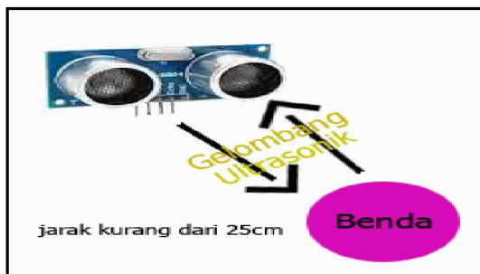
Gambar 3. Jarak sensor ultrasonik ke benda
