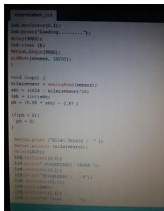
Gambar 6 Coding Bahasa Pemrograman C Pada Software Arduino
