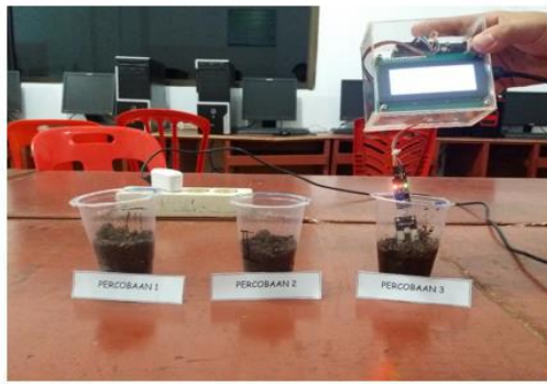
Gambar 5 Uji Coba Alat Dalam Menentukan Tingkat Kesuburan Tanah Berbasis Expert Sistem
